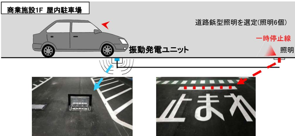
開発した振動発電システム
